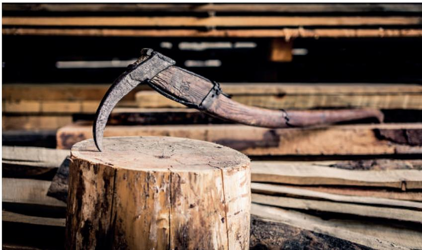
Früher wurde der Zapi vor allem für das «Reisten» oder «Feldern» von Holzstämmen verwendet. Reisten und Feldern bedeutet, das Holz mit Hilfe der Hebelwirkung des Zapi's im Steilhang zu bewegen und nach unten zu verschieben. Damit die Stämme besser rutschten wurden die Kanten der Stämme gebrochen (spermielen). Sauber und stammglatt geastete Bäume waren Voraussetzung für einen reibungslosen Ablauf der Arbeit.
